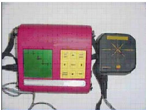
La estimación de la profundidad a la que se encuentran las barras de refuerzo es útil cuando hay que remover parte de la superficie para trabajos de mantenimiento.
