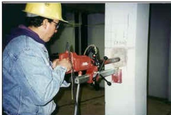
Sin embargo, como la mayoría de los problemas tiene más relación con la durabilidad que con la resistencia, raramente estos testigos se ensayan la compresión simple y, mas bien, son usados para análisis petrográficos de aire incorporado y para pruebas de contaminación química. Como esta prueba es costosa y destructiva, los testigos se extraen solo cuando es necesario efectuar investigación adicional.
