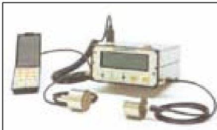
La prueba evalúa la homogeneidad y determina la ubicación de las fisuras. El resultado puede ser afectado por muchos factores, incluyendo la variación de los agregados y la ubicación del acero de refuerzo. Se obtiene resultados cuantitativos, pero ellos son de naturaleza relativa, por lo que es necesario correlacionarlos con testigos, para conseguir valores absolutos.
